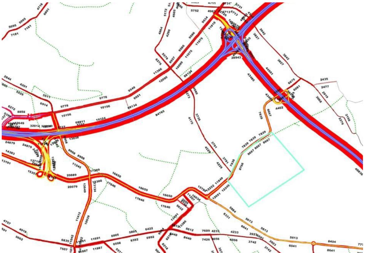
Abbildung 4.3-1: Netzbelastung 2030 ohne Innovationspark (Fahrzeuge / Werktag – DWV, Quelle: AFV, Gesamtverkehrsmodell Kanton Zürich 2012)
