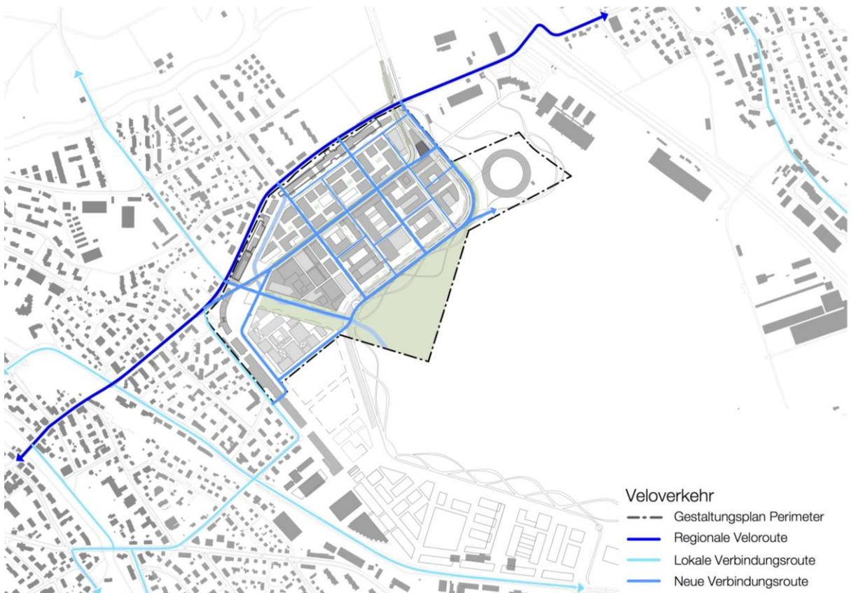
Abb. 44: Erschliessungsschema Veloverkehr (Quelle: IBV Hüsler)
